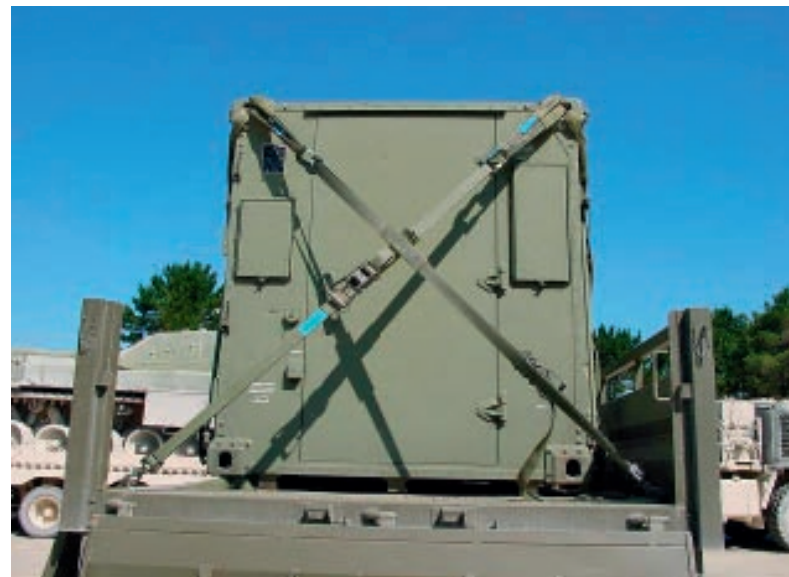
PARTICOLARE DI SHELTER CARICATO SU MEZZO IVECO
