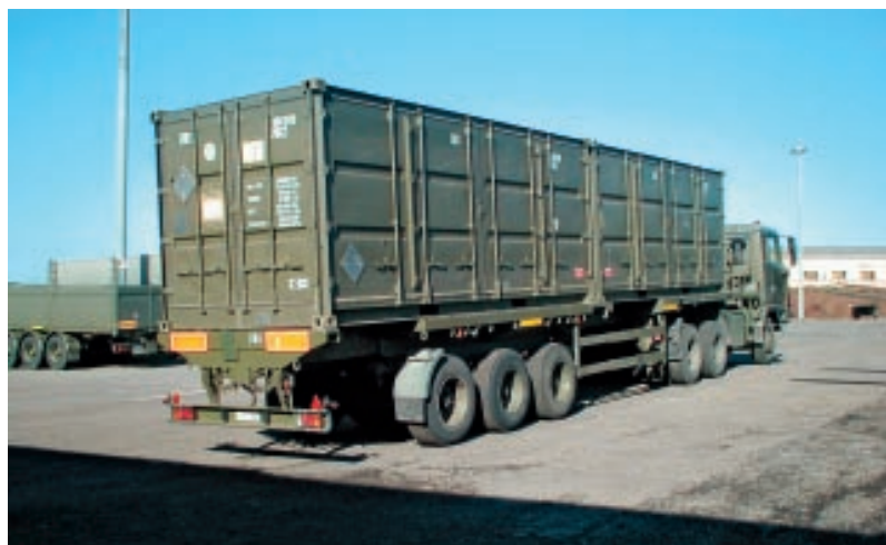
PARTICOLARE DEL MEZZO IVECO / ASTRA APS 95 E (foto successiva) HD 7 CON SEMI-RIMORCHIO ALLUNGABILE
