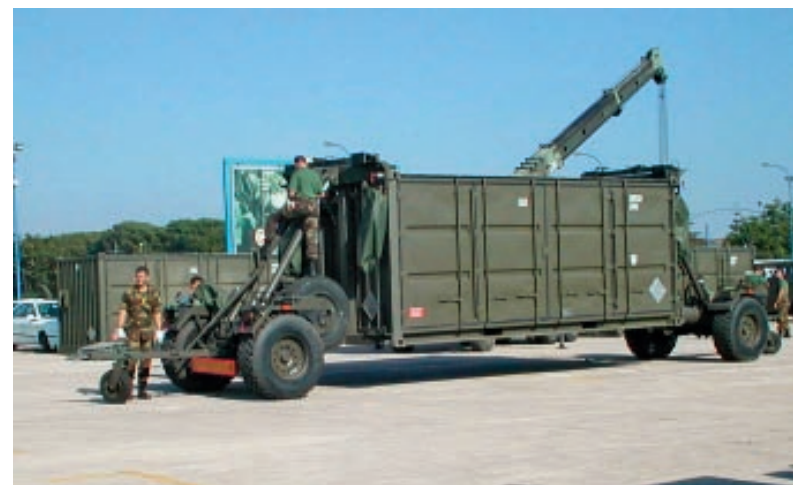
PARTICOLARE DEI MEZZI PER LO SPOSTAMENTO DEI CONTAINERS IN ZONE LIMITATE
