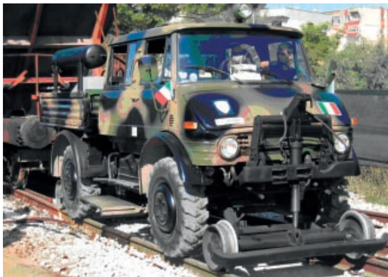
ALBANIA _PORTO DI DURAZZO MEZZI STRADA - ROTAIA IMPIEGATI PER IL RIPRISTINO DELLA RETE FERROVIARIA.
