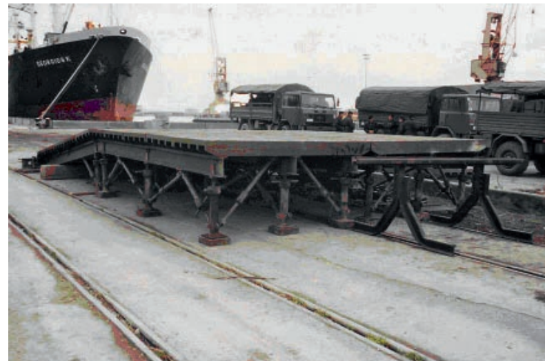
PIANO CARICATORE SCOMPONIBILE IN FERRO LEGNO III / 9 UTILIZZATO NEL PORTO DI GENOVA DA UNITÀ MILITARI IN RIENTRO DAL LIBANO.
