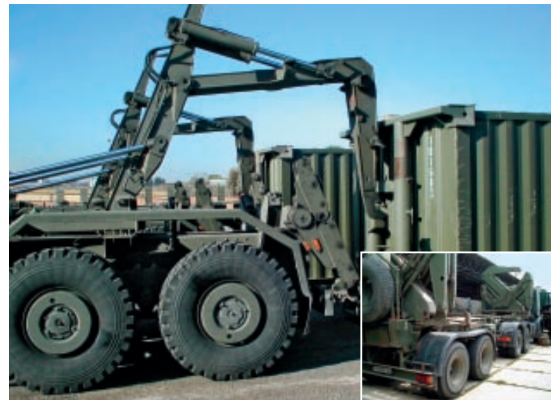
PARTICOLARE DEL MEZZO IVECO / ASTRA A PIANO SCARRABILE
