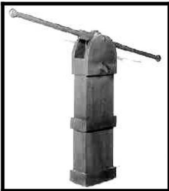
*Ricostruzione della pompa a stantuffi di Nemi.*
