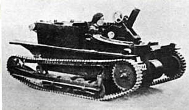
*Foto 2. Un Carden Loyd versione Mortaio. L'Italia sviluppò sul modello CV 33 versioni speciali come il carro lanciafiamme e il carro radio. Interessante e audace fu la versione del CV 33 come carro pontiere*
