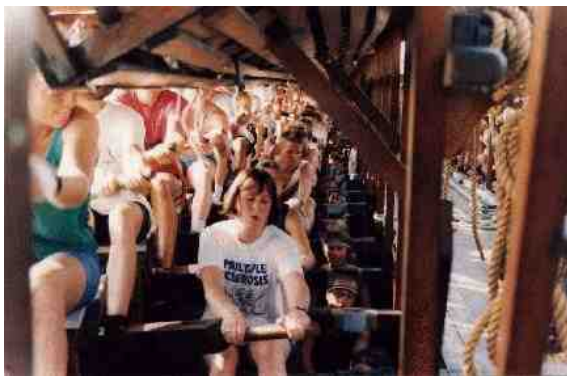
Interno dell' Olympiás con le corsie dei thraniti, zygiti e, in basso a destra, dei thalamiti.
