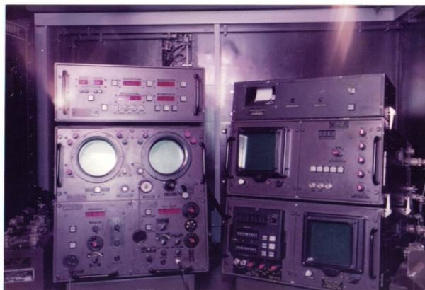
**INTERNO DEL SISTEMA INTERCETTO-LOCALIZZATORE DI RADAR RAFI FALCO**
