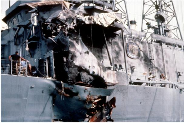
**I DANNI CAUSATI DAI DUE MISSILI ANTINAVE EXOCET ALLO SCAFO ED ALLA SOVRASTRUTTURA DELL'USS STARK**
