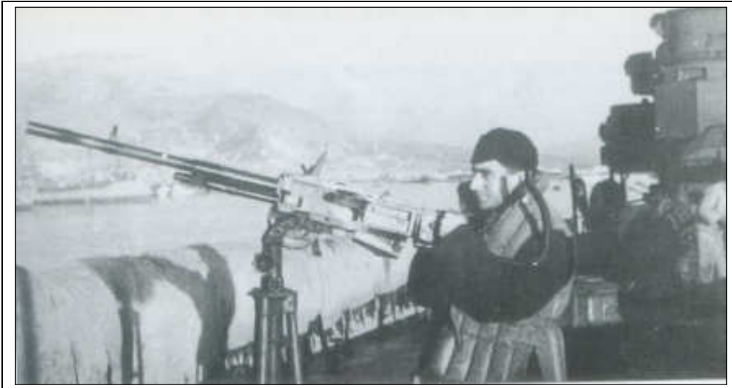
Mitragliatrice "Breda 1937" da 8 mm su affusto a candelieri con funzione anti mezzi insidiosi all'ancoraggio.
