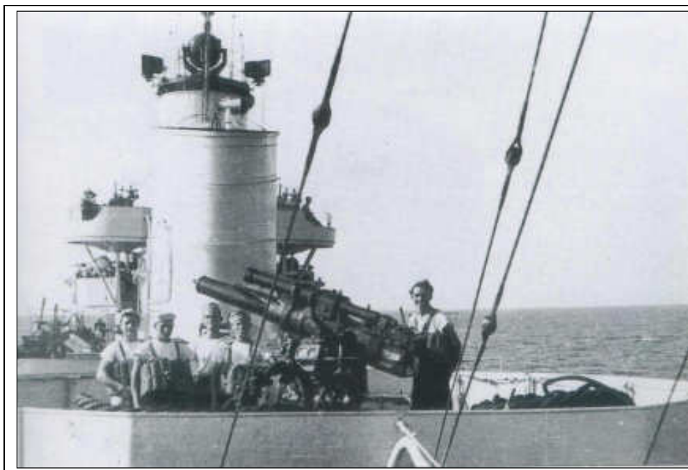
Obice da 120/15 mm mod. "OTO 1934" per il tiro illuminante sistemato sulla tuga centrale su tutti i caccia della 1 a serie eccetto il Carabiniere , che invece aveva un cannone da 120/50 scudato.
