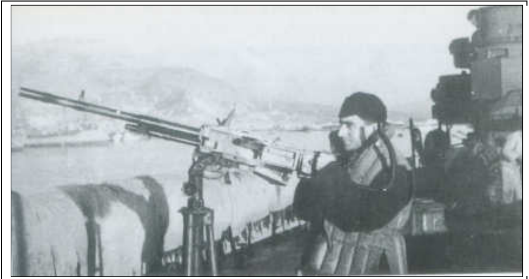
Mitragliatrice "Breda 1937" da 8 mm su affusto a candeliere con funzione anti mezzi insidiosi all'ancoraggio.
