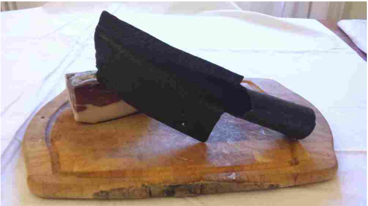
Fig. 8a e 8b – Coltellaccio per macelleria da pezzo di pala. Una pala di ordinanza è stata tagliata, adattata ed affilata come coltello da cucina.
