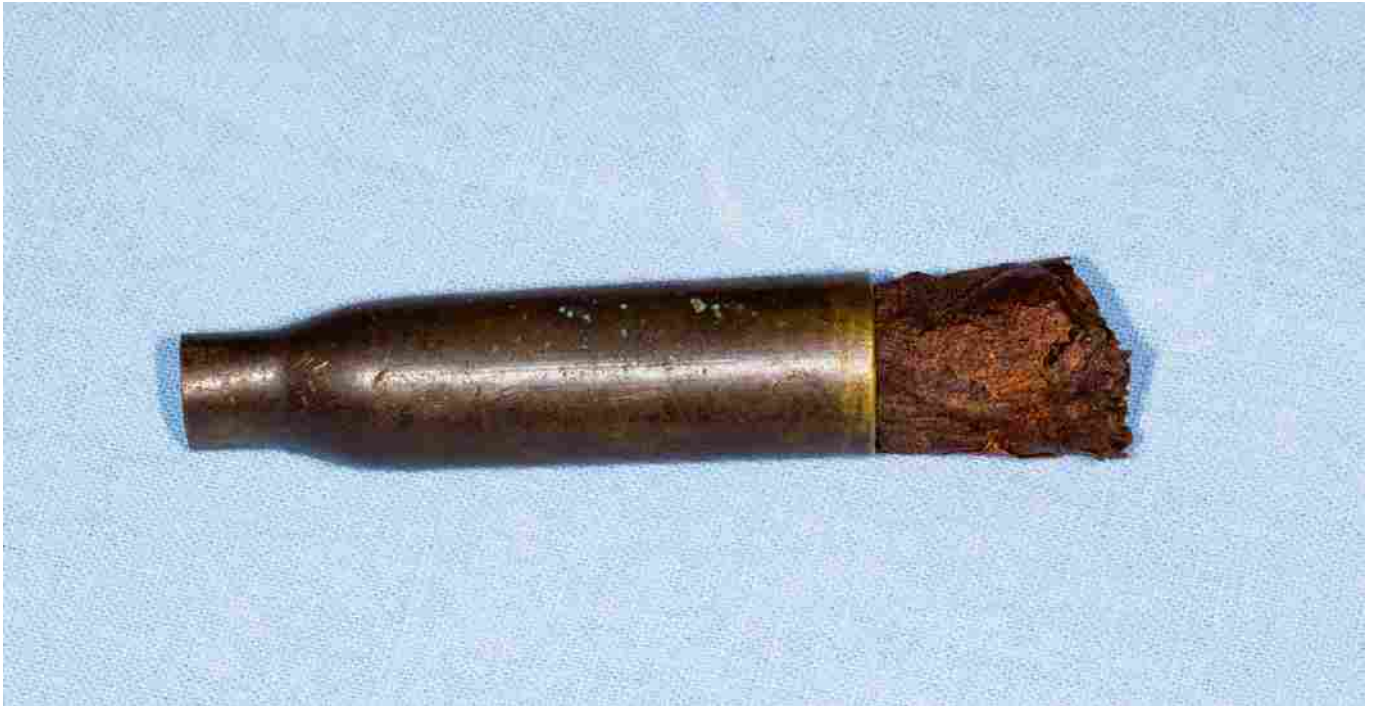
Fig. 14 - Bossolo munizionamento Mannlicher trasformato in bocchino per sigaro. Il bossolo di calibro 8 mm è stato segato nella suo lato inferiore per accogliere il sigaro e schiacciato in quello superiore per aspirare.
